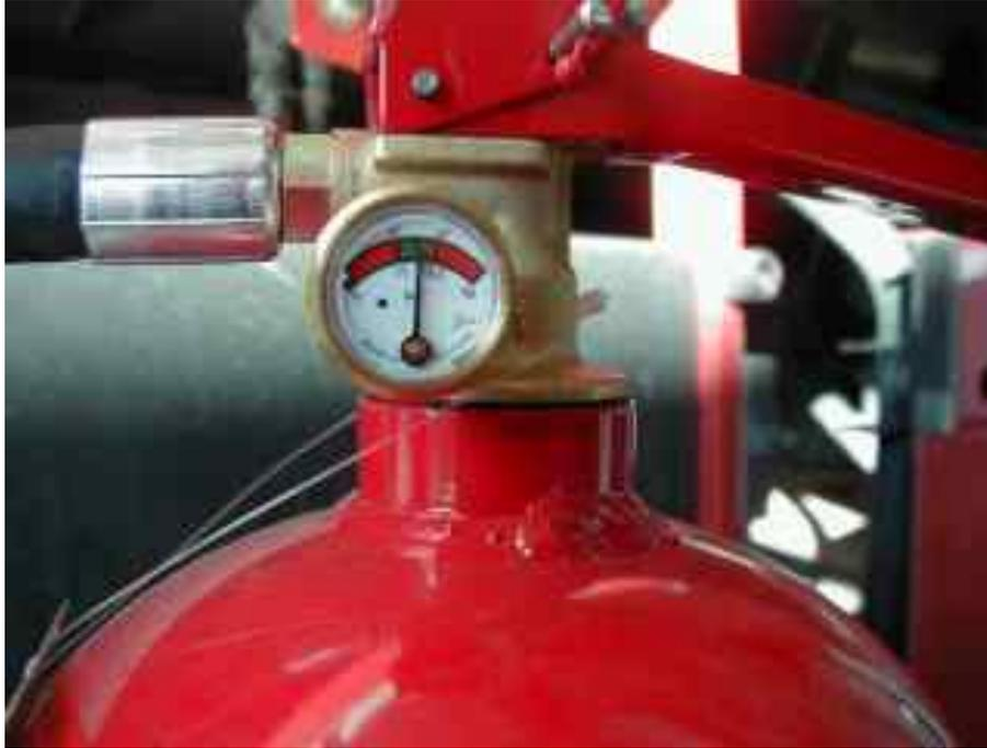
**Il manometro, strumento che ci permette di controllare la pressione dell'estintore.**
